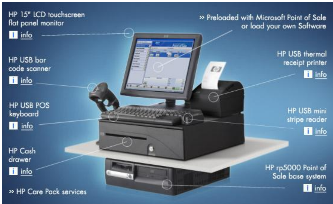
รูปที่ 1 แสดงองค์ประกอบโดยทั่วไปของ Point of Sale
